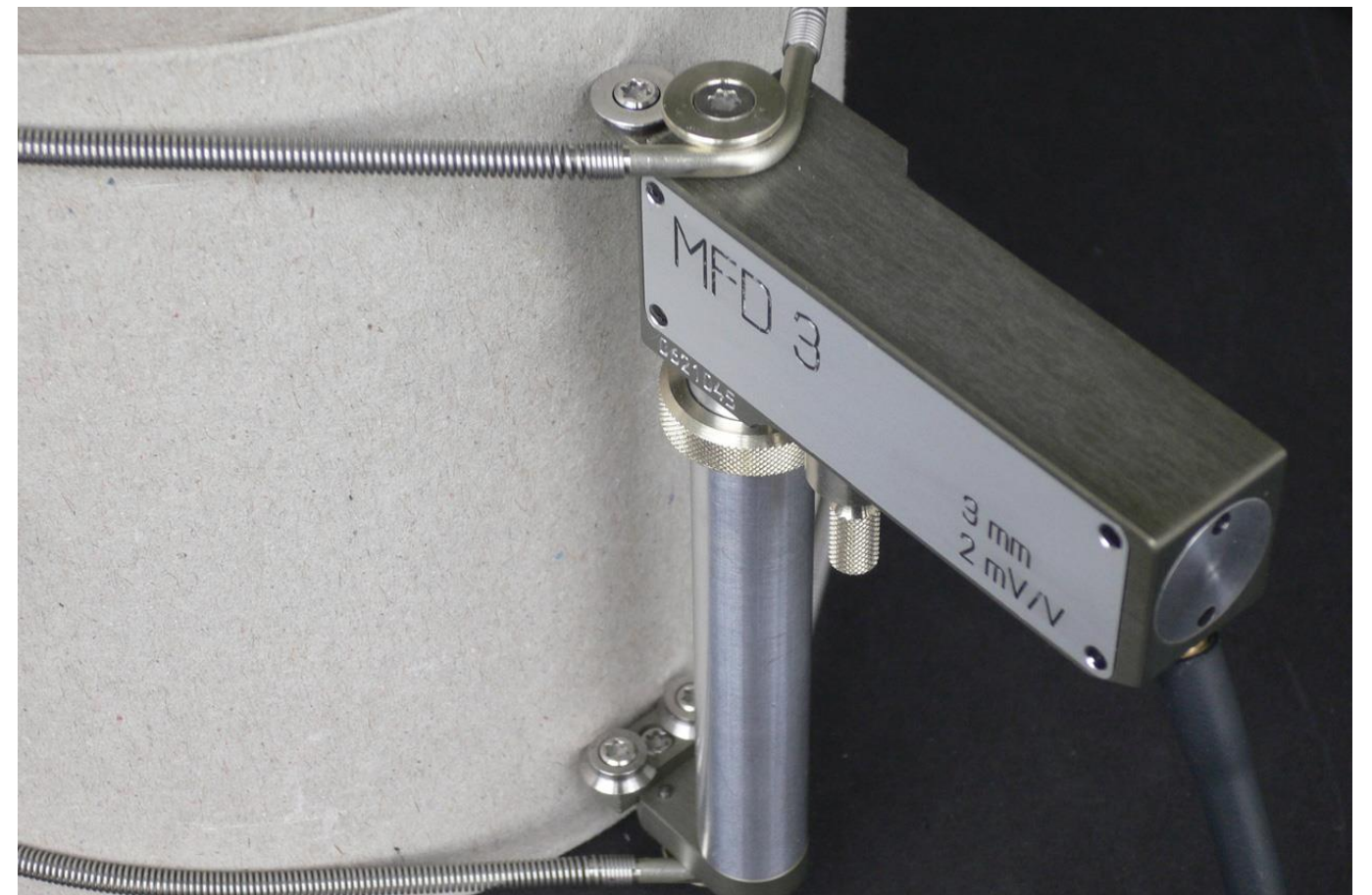
Bild 2: Sitz der Winkelstücke am Messwertaufnehmer
